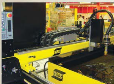
Máquina de Oxicorte - esteiras em paralelo.
